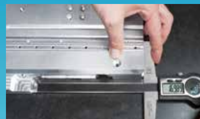
Měření hloubky otvoru
